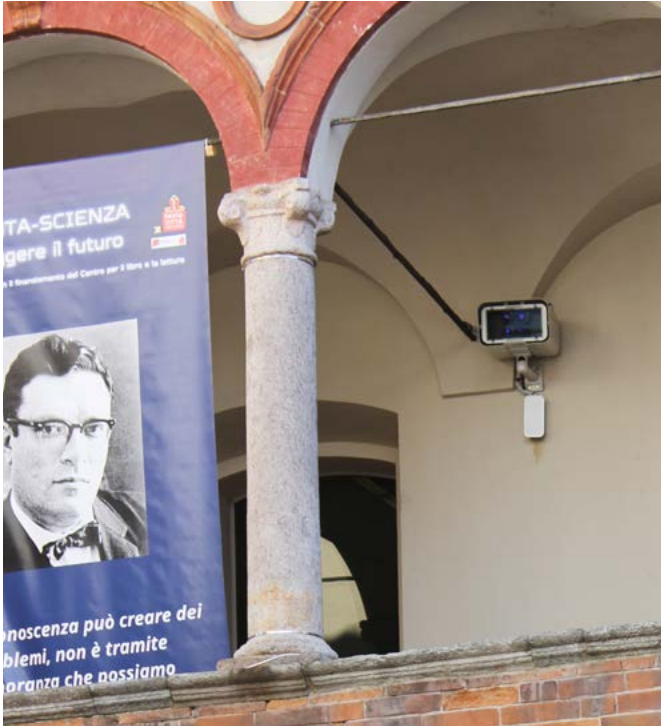
Dos cámaras de sensores multifocales Panomera® son suficientes para cubrir toda la Piazza della Vittoria.
