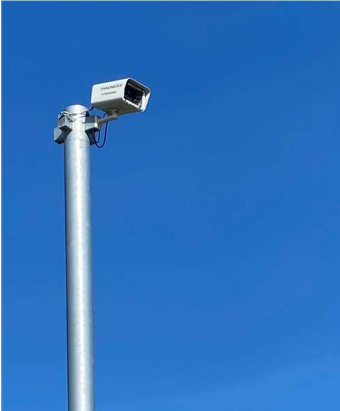
*La patentada tecnología Panomera® trabaja con ópticas de diferentes distancias focales en un único sistema. Por esa razón, bastan muy pocos sistemas para cubrir en alta resolución superficies grandes en el exterior.*
